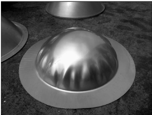
图 5 第一步工序起皱工程实物图
