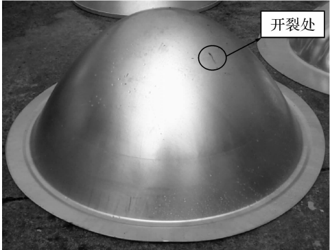
图 8 第二步工序开裂工程实物图
