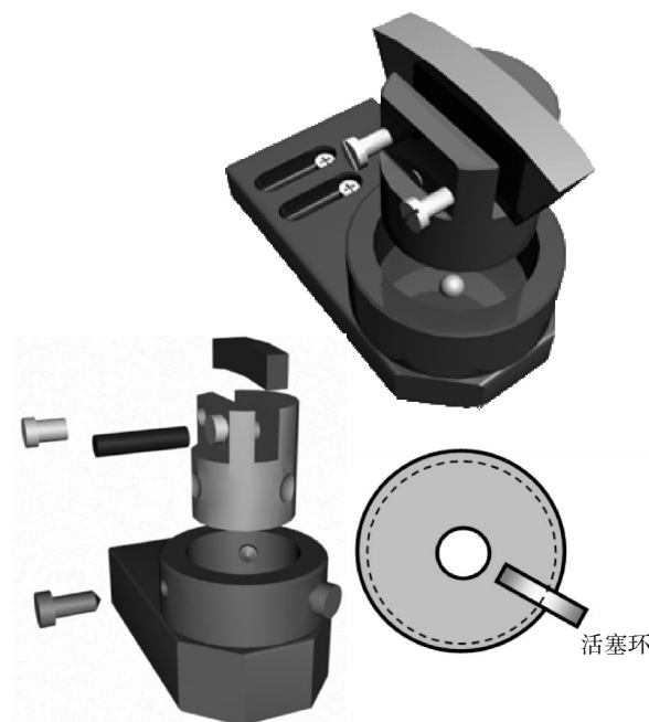
图 2 活塞环装夹示意图
